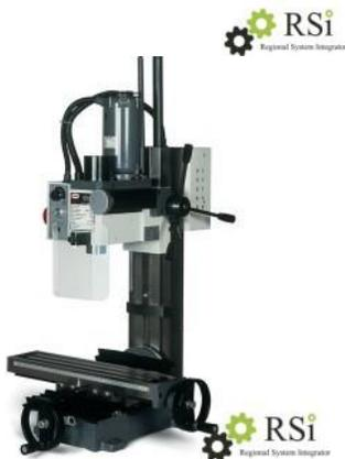
**Вертикально фрезерный станок, оснащенный щитком-экраном из оргстекла FPX-25 E** - используется для того, чтобы обрабатывать элементы и корпуса, выполненные из различных материалов, металла, пластика и так далее. При помощи станка можно выполнять следующие операции: проточка, сверление, обработка кромок, развертка.
