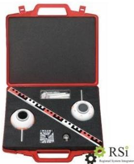
**Комплект демонстрационного оборудования "Модель глаза человека" с руководством для учителя** - демонстрирует оптические функции глаза – такие, как создание изображения объекта на сетчатке, аккомодация (изменение кривизны линзы), близорукость и дальнозоркость. Материалы поставляются в пластиковом чемодане и удобны для использования и хранения.
